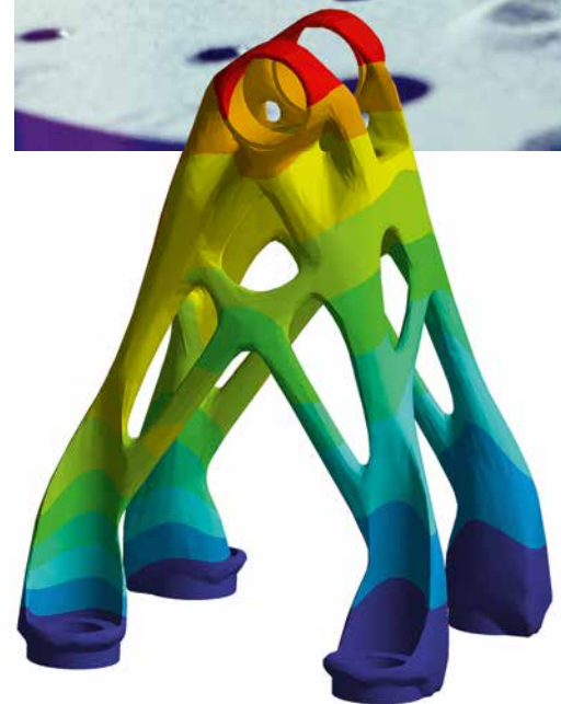
Bild 1: Prognose des Verzugs beim Druckprozess als Grundlage für Geometriekompensation.
